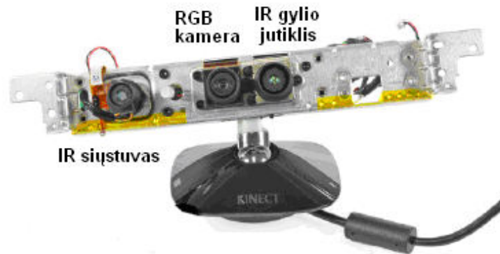
1.2 pav. Kinect jutiklio sudedamosios dalys: IR siūstuvus, RGB kamera, IR gylio jutiklis [7]
