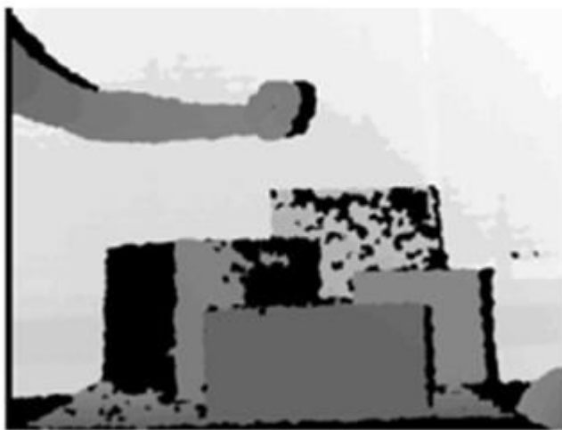
1.11 pav. Kinect jutikliu gautas gylio vaizdas. Šviesesnės sritys yra toliau, o tamsesnės arčiau [41]
