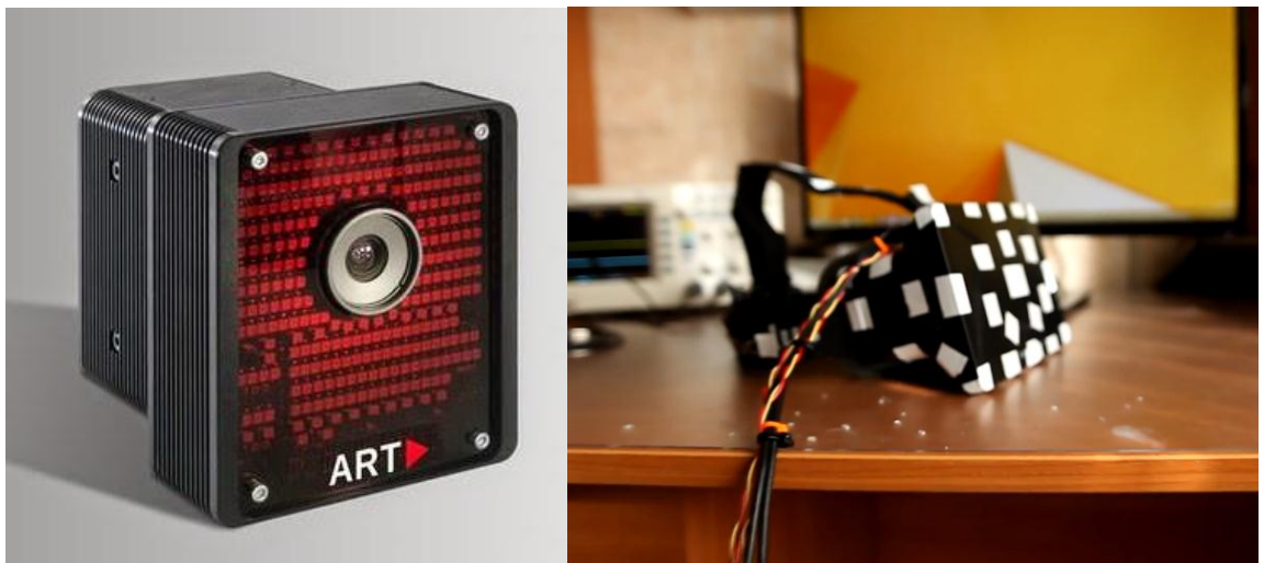
1.11 pav. Kairėje – vaizdo kamera su IR šaltiniu. Dešinėje – virtualios realybės šalmas su šviesą atspindinčiais žymekliais
