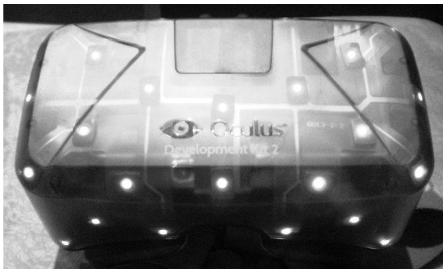
1.12 pav. Aktyvūs IR žymekliai po Development Kit 2 įrenginio permatomu plastikumu
