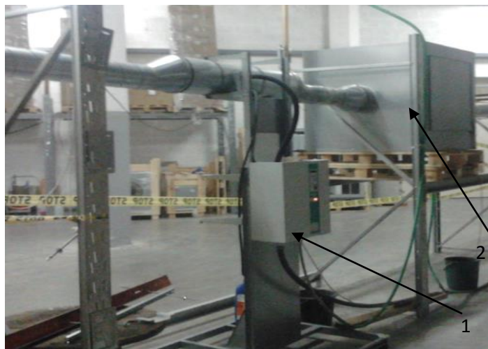
2.15 pav. Patalpos drėgmės ir temperatūros imitavimo moduliai: 1 - oro drėkintuvas; 2 - garų surinkimo kamera
