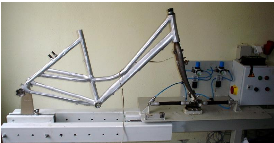
1.2 pav. Rėmo dinaminio bandymo horizontalia jėga stendo vaizdas
