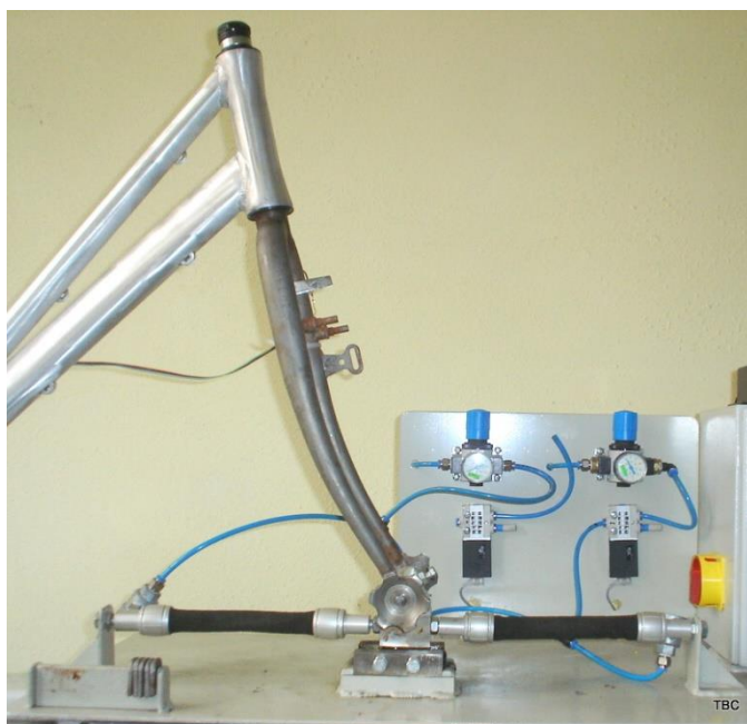
2.1 pav. ETL stendo pneumatinių raumenų DMSP-20 sąranka
