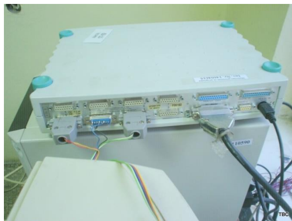
2.10 pav. „Spider 8-30” vaizdas iš galo (įrenginio schema ir įrenginio pajungimo bandymų metu vaizdas)
