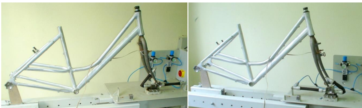
2.11 pav. Srankos statinis bandymas kai atskirai veikia dešinysis ir kairysis pneumatinis raumuo
